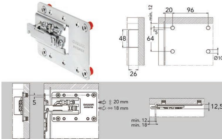
**Système de suspension type 807 XL pour armoires basses avec anti-décrochement**
