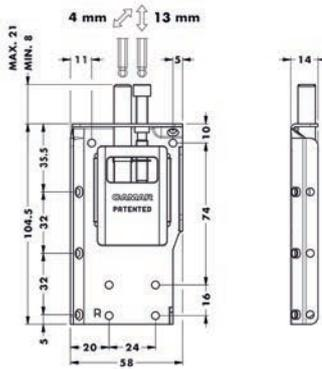
**Système de suspension type 822 avec anti-décrochement**
