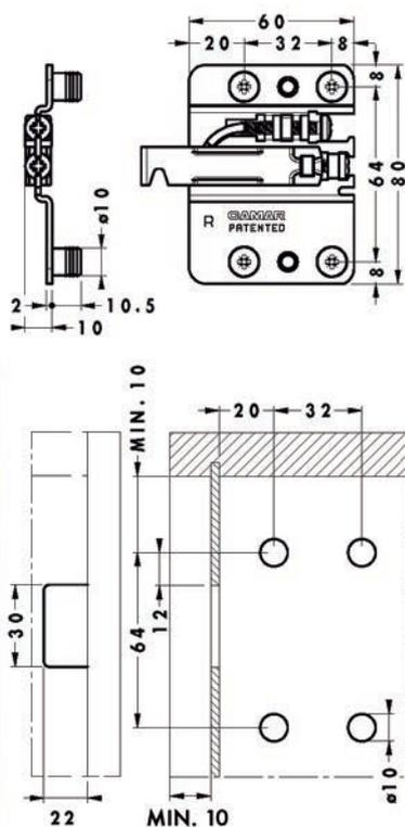
**Système de suspension type 807 pour armoires basses avec anti-décrochement**
