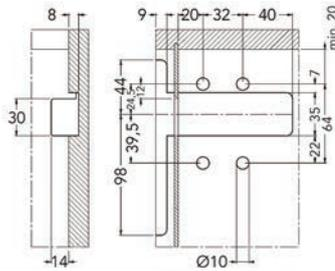
**Système de suspension à encastrer type 807 RV pour armoires basses avec anti-décrochement**
