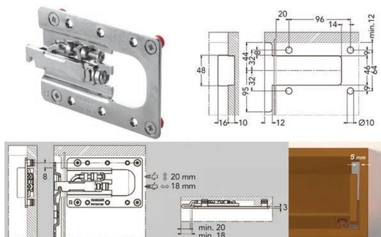
**Système de suspension à encastrer type 807 RV XL pour armoires basses avec anti-décrochement**
