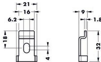
**Plaquette de fixation type 814.AC.Z1.16.35**
